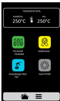
c) Задайте параметры времени, температуры, скорости подачи горячего воздуха и работы нижнего нагревателя (инфракрасного).
